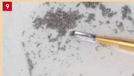
Fig. 9 : copeaux d'alliage métallique non précieux générés par la découpe d'une infrastructure métallique.
