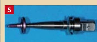
Fig. 1 : pilier plein et col de l'implant trans-gingival fraisés, suite à une manœuvre inappropriée de dépose de couronne
