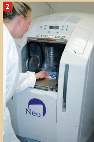
**Fig. 2 : Imprimante 3D** (modèle InVision® HR, de chez 3D® SYSTEMS, distribuée sous le nom NEO™ par la société CYNOVAD) Cette machine-outil imprime les maquettes sur leur support. Elles sont récupérées le lendemain matin lorsque l'impression est lancée le soir.
