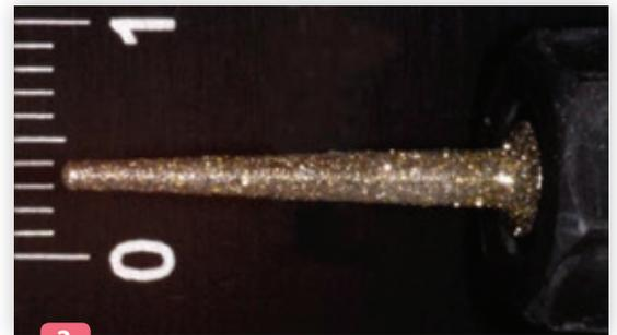
**Fig. 2 :** détail de la fraise de l'usineuse CS3000 (Carestream™).
