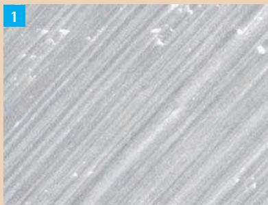
Comparaison entre surface usinée et surface modifiée, ici, TiUnité® en microscopie électronique à balayage (© Copyright avec l'aimable autorisation de Nobel Biocare)
