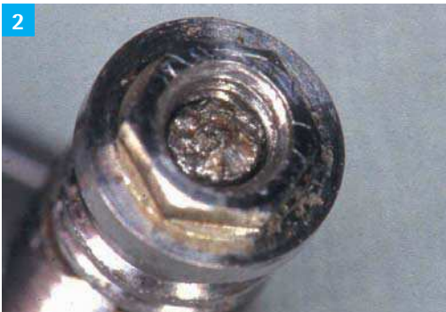
Fig. 2 : L'examen d'une vis fracturée montre que sa surface est piquetée, caractéristique d'une fracture de fatigue.
