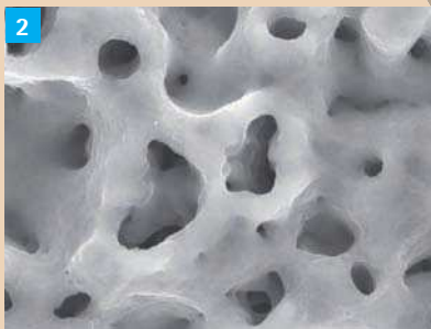
Comparaison entre surface usinée et surface modifiée, ici, TiUnité® en microscopie électronique à balayage (© Copyright avec l'aimable autorisation de Nobel Biocare)
