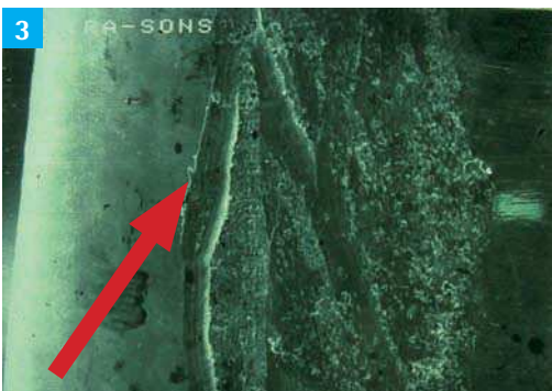
Fig. 3 : Lorsqu'une pointe à ultra-sons est promené sur une surface de titane, elle crée des rugosités importantes allant parfois jusqu'à des ébarbures (flèche), interdisant à la partie de vis fracturée de remonter.
