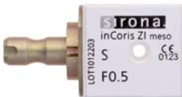
Les blocs en oxyde de zirconium sont partiellement frittés et présentent une géométrie de la connexion préfabriquée qui permet le collage précis de la mésostructure sur les bases en titane CFAO CAMLOG®. Les blocs en oxyde de zirconium existent en deux teintes naturelles (F0.5 et F2) et dans les deux tailles Large et Small. Ils sont usinés avec la meuleuse MC XL de Sirona Dental Systems GmbH.
