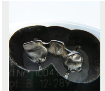
neuse 5 axes à commande numérique pour commencer l'usinage dans un bloc de CoCr. Un système de projection d'eau permet d'éviter que soit générée de la chaleur.
