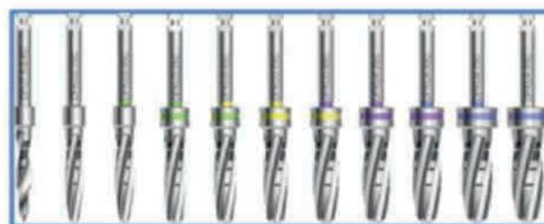
Le design homothétique des forets à la silhouette des implants favorise l'intimité initiale os-titane ainsi que l'uniformité de la stabilité primaire sur la surface d'ancrage. L'incrémentation progressive des diamètres permet d'ajuster de façon précise et atraumatique le forage terminal à l'os. Un double code couleur didactique permet de travailler de façon reproductible et prévisible. Le protocole Ultimate est commun aux implants In-Kone® Universal, TwinKon® et In-Kone® Primo.
