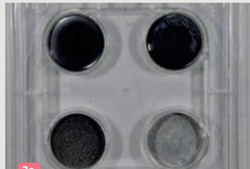
**Fig. 3a : dispositif pour vérification de la biocompatibilité de l'état de surface.**
