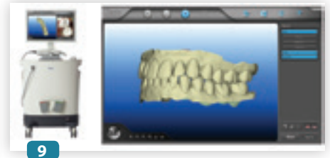
Fig. 9 : iTero® Orthodontic (AlignTech) : un scanner intra oral dédié à l'orthodontie.
