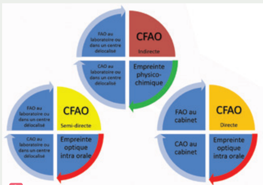
Fig. 2 : les différents types de CFAO : indirecte, semi-directe et directe.
